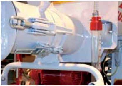
Cámara de mezclado
