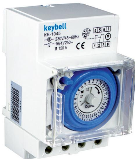
Interruptor programador horario analógico con reserva de marcha de 150 horas y programa de 24 horas - 48 On/Off e intervalo de 30 minutos. Este programador horario es apto para la programación diaria de un circuito eléctrico (calefacción, ventilación, iluminación) mejorando la gestión de la instalación.
