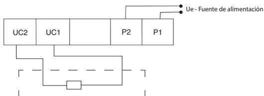
Cuando la tensión de funcionamiento corresponda al 35%~70% de la tensión nominal, la bobina de disparo hará que la caja moldeada se dispare correctamente.
