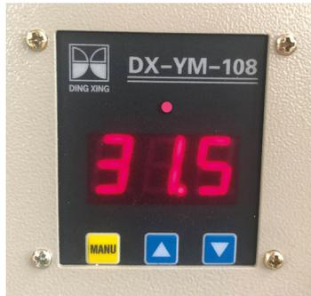
mación, con los pulsadores azules de positivo y negativo es posible desplazarse por el menú aumentando y disminuyendo los valores de temperatura. Una vez fijados, presionar el pulsador amarillo para iniciar el proceso. Seguidamente, se encenderá un LED rojo de la temperatura programada. Este LED nos confirma que el programador se ha activado para alcanzar la temperatura de trabajo programada.
