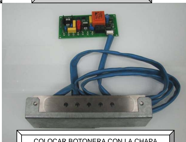
COLOCAR BOTONERA CON LA CHAPA PEGADA DETRÁS DEL SOPORTE DE CHAPA Y ATORNILLARLO.
