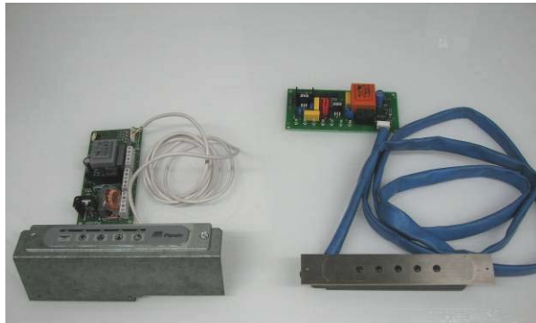
A LA IZQUIERDA TENEMOS LA BOTONERA DE MEMBRANA 0407000 CON CIRCUITO E-677. A LA DERECHA TENEMOS LA BOTONERA ELECTRONICA E690 CON CIRCUITO E-1000.
