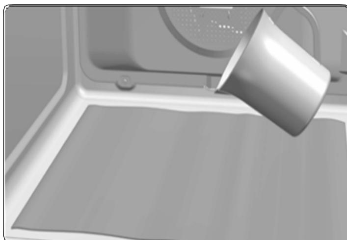
2. Vierta lentamente 200 ml de agua en la parte inferior de la cavidad del horno.
