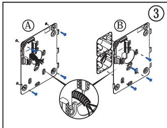
Fijación de base mural sobre pared (A) o sobre 2 cajas de mecanismos universales (B)
