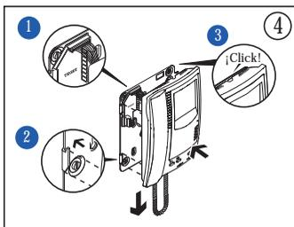
Conexión y colocación de monitor sobre base mural.
