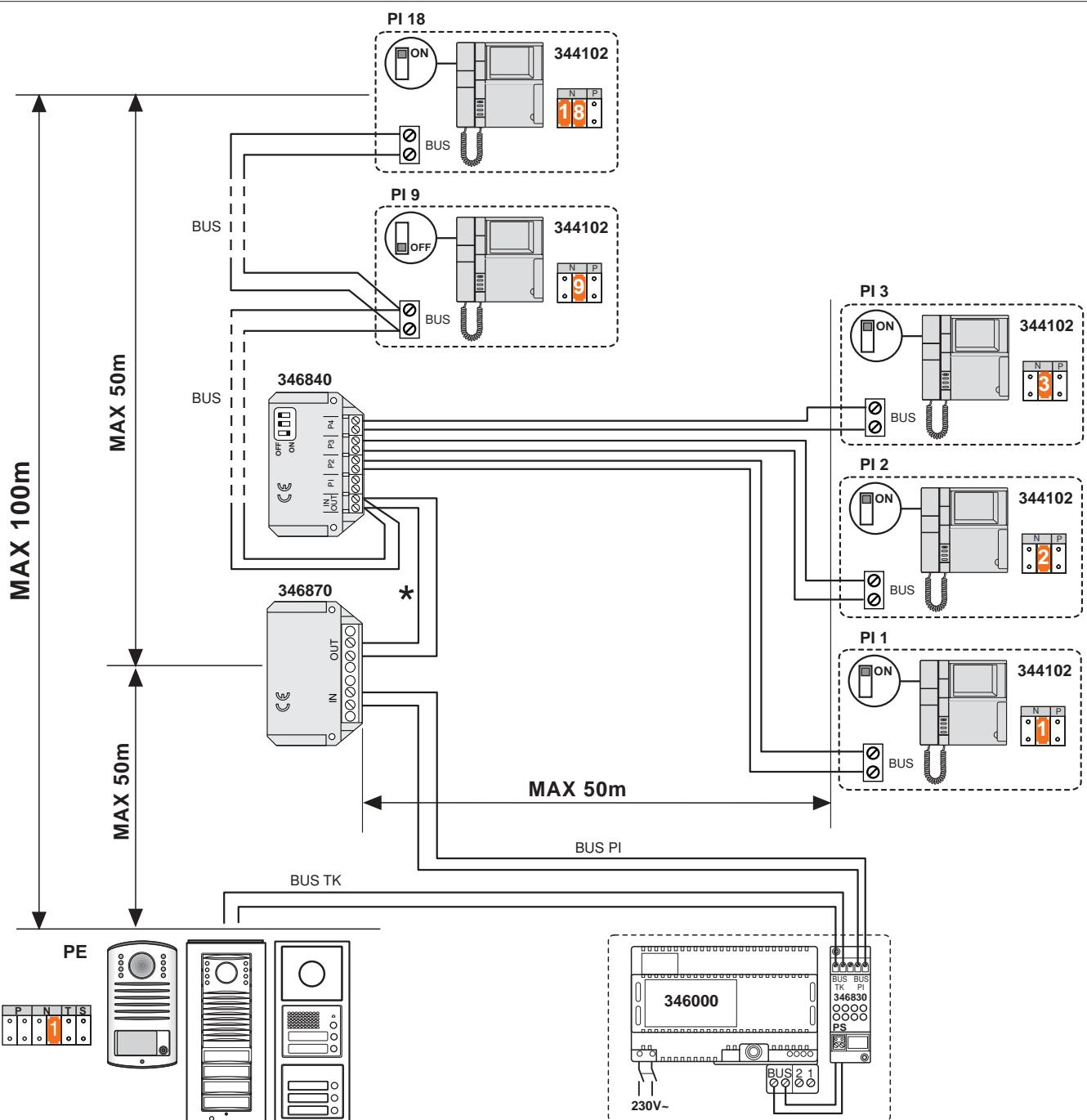
**I** L'art. 346870 consente di realizzare impianti con il sistema 2 fili e cablati con cavi normali (non twistati) aventi sezione  $\geq 0,28 \text{ mm}^2$ , dove la distanza tra PE e PI più lontano supera i 50 m e l'immagine sul video è disturbata o di scarsa qualità.
