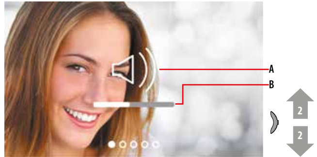
La página muestra el tipo de parámetro (A) y el nivel configurado (B) 2 Mueve el joystick hacia arriba o hacia abajo para seleccionar el tipo de parámetro del cual quieres modificar el valor (ver tabla siguiente)
