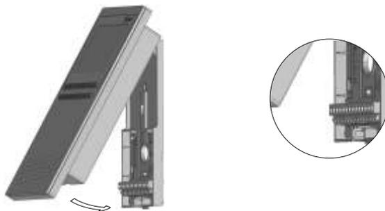
Pour ouvrir le moniteur, utiliser un tournevis plat pour effectuer une pression sur le crochet de fixation de la réglette. Une fois le moniteur libéré, ouvrez-le en tirant vers vous et séparez-le de la réglette, en faisant attention qu'elle ne tombe pas.
