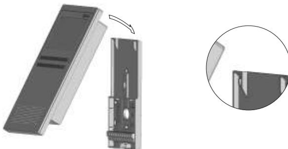
Fermer le moniteur en exerçant une légère pression sur la partie inférieure du moniteur jusqu'au 'clic' de fixation de la réglette.
