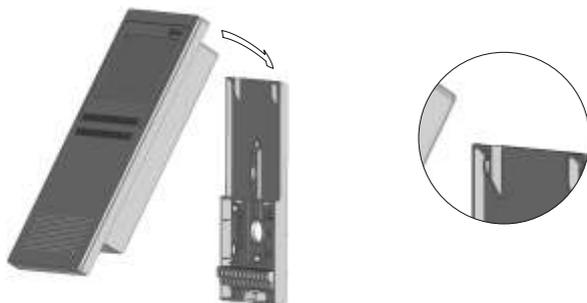
Cerrar el monitor ejerciendo una leve presión sobre la parte inferior del monitor y hasta escuchar el 'clic' de la pestaña de fijación de la regleta.
