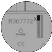
Le pontet de fin de ligne est placé sur le module de vidéo du connecteur CN2, situé sur la partie arrière du moniteur.
