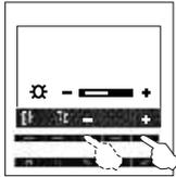
Pour sélectionner l'option de luminosité ☒ presser le poussoir du menu indiqué, puis augmenter ou diminuer la valeur selon la luminosité souhaitée. Sélectionner l'option OK pour enregistrer ou l'option ↵ pour sortir sans modifier.
