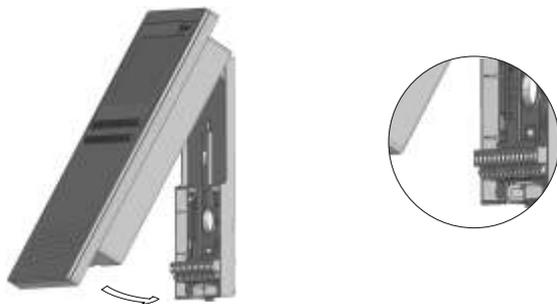
Si se desea sacar el monitor una vez instalado, realizar una leve presión mediante un destornillador plano sobre la pestaña de fijación de la regleta. Una vez liberado el monitor, abrirlo tirando hacia usted y separarlo de la regleta; con cuidado de que no caiga.
