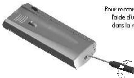
Pour raccorder et fixer le poste d'appel, ouvrir le poste d'appel à l'aide d'un tournevis plat, en exerçant un mouvement de levier dans la ranure prévue à cet effet (voir le dessin ci contre).
