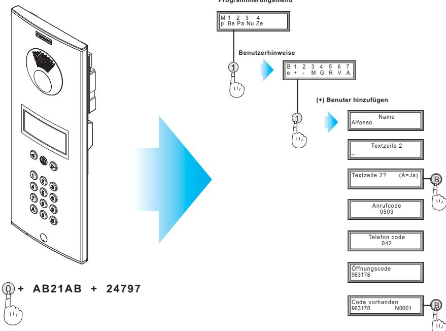
Die Programmierung des „Rufcodes“ wird durchgeführt, so wie im Diagramm beschrieben. Die vorangehende Sequenz beschreibt wie Benutzer in der Türstation MIT Bildschirm einprogrammiert werden. **In diesem Dokument wird dieser Vorgang detailliert erläutert.**
